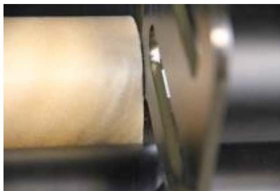
Рисунок 6-57 : Зазор в 2мм между трубой и ограничителем
