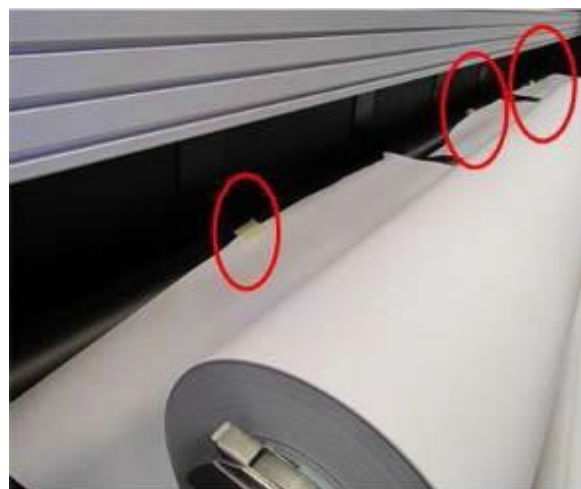
Рисунок 6-28: Край материала приклеен к валу (F)
