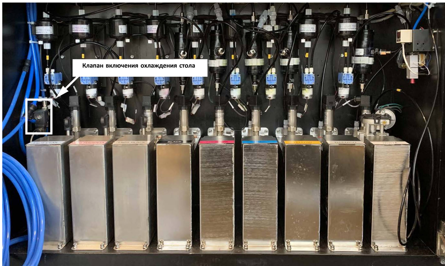
Рисунок 3-23: Клапан включения охлаждения стола
