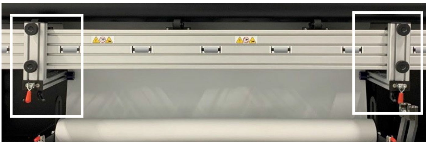
Рисунок 6-38 Ролики Spreader на краю материала
