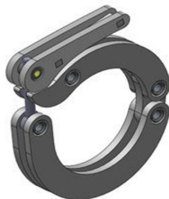
Рисунок 6-30: Фиксатор положения рулонов - Защелкнут
