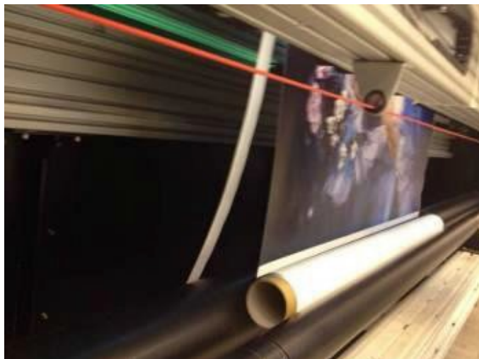
Рисунок 8-10 : Обрезки материала падают с принтера
