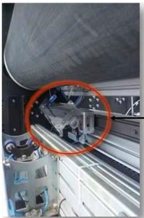
Рисунок 8-11 : Устройство ID Backprint (на фото демонтирован прижимной вал)
